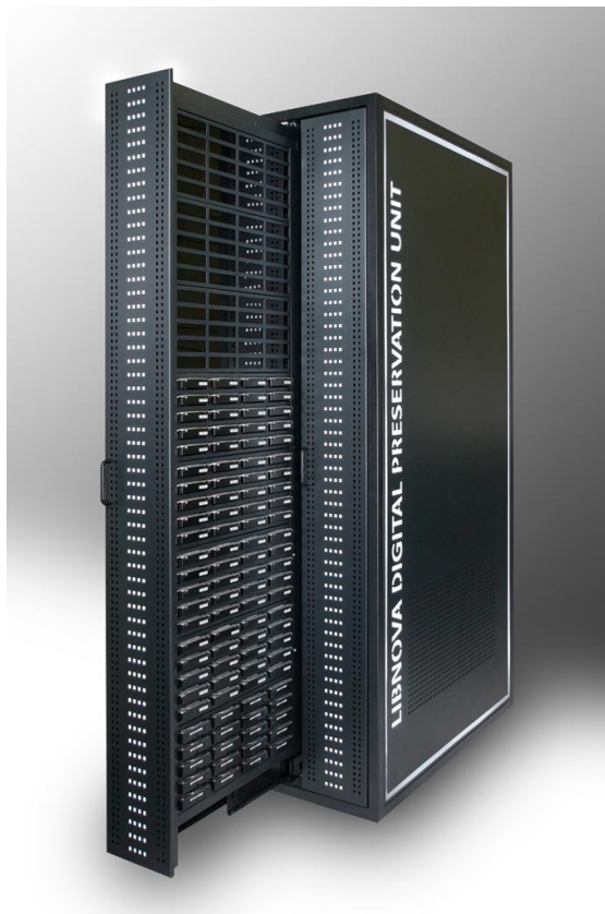
Sistema de almacenamiento masivo en discos duros de Libdata. Fuente: Libnova
