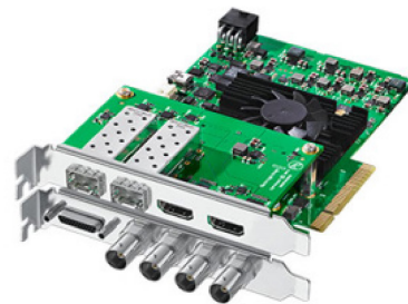
Tarjeta Blackmagic DeckLink 4K Extreme 12G. Fuente: Blackmagic
