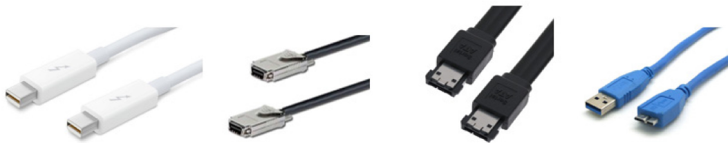
Conectores Thunderbolt., SAS, eSATA y USB 3 / Micro USB 3
